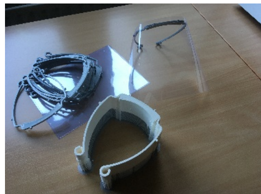
Abbildung 3: Schutzequipment aus dem 3D-Drucker, hier ein Nackenschoner für Gesichtsmasken (Foto: Dagmar Härter)
