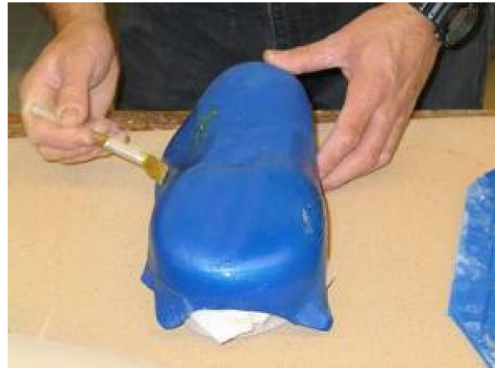
Abbildung 11: Verkleben der verschiedenen Materiallagen auf dem Gipspositiv
